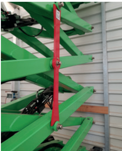
Wartungsstütze für sicheres Arbeiten an einer Hubarbeitsbühne (Fa. Dummer, Pritzwalk)
