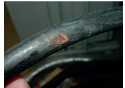
Gefahr durch beschädigte Hydraulik-Schlauchleitungen (IHA, Dresden)
