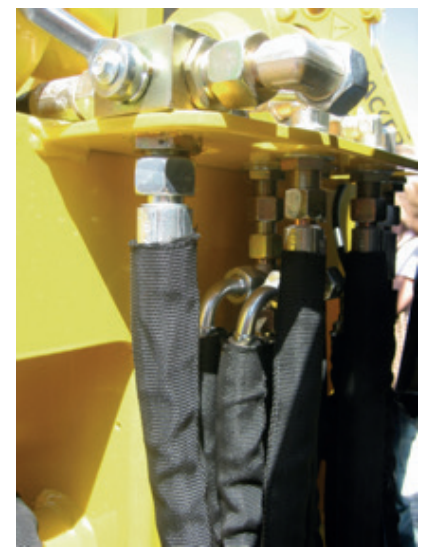
Schutzschläuche vermeiden den Austritt von Druckflüssigkeiten (IHA, Dresden)
