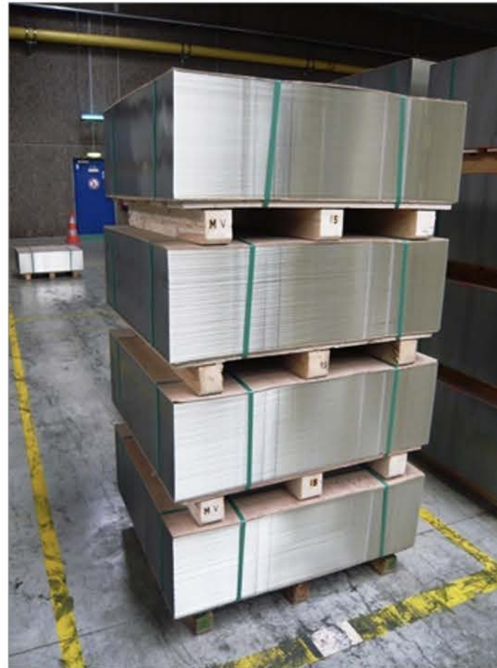
Beförderungssichere Ladeeinheiten: Weißbleche auf Einwegpalette mit Umreifungsbändern umschlossen. So ist es richtig!
