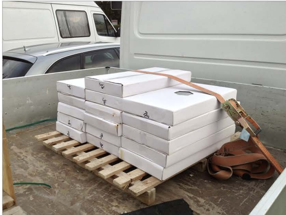
Mangelhafte Transportverpackung. Ladungssicherung ist so nicht möglich .
