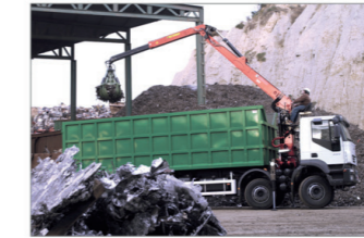
Klassisch verfahrbarer Lkw-Ladekran – zum Be- und Entladen der Ladefläche des Lkw konzipiert.
