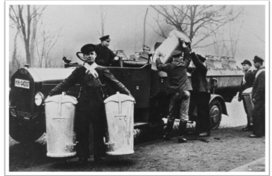
*Ende der 1920er Jahre: Motorisierte Müllabfuhr mit Tonnenumleersystem in Hamburg.*
