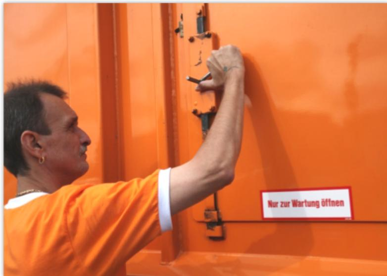
*Wartungsklappe erst öffnen, wenn die gefahrbringende Bewegung im Abfallsammelfahrzeug stillgesetzt und es gesichert ist.*
