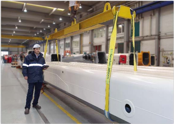
Umgelegte Last – mit Kantenschonern zum Schutz für das Hebeband.
