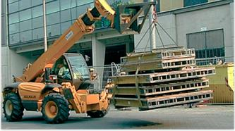
Bei der Fahrt auf unebenem Gelände entstehen durch den Hebeleffekt des Vorbaus erhebliche **Zusatzkräfte**. Mindestens eine Tragfähigkeitsstufe (Nenndicke) dicker auswählen!
