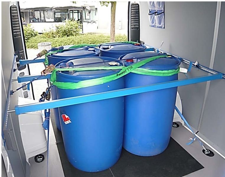
Kombinierte Sicherung von Fässern in einem Kastenwagen
