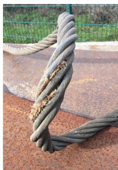
Beschädigte Anschlagseile nicht mehr verwenden!
