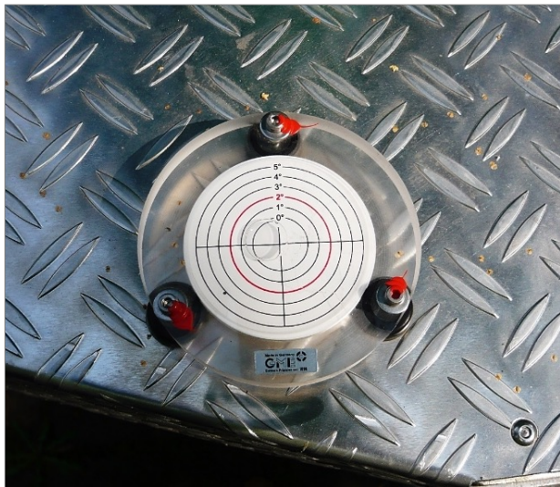
Dosenlibelle am Fahrwerk. Aufstellung der Maschine waagrecht?
