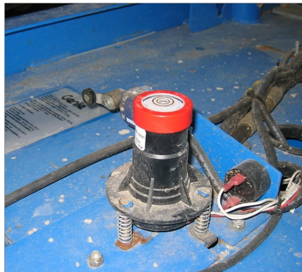
Neigungssensor einer Hubarbeitsbühne. Funktion vor Arbeitsschicht geprüft?
