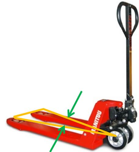
Schmales Standsicherheitsdreieck eines Handhubwagens. Die Pfeile kennzeichnen die Kippkanten.
