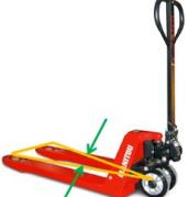
Schmales Standsicherheitsdreieck eines Handhubwagens. Die Pfeile kennzeichnen die Kippkanten.
