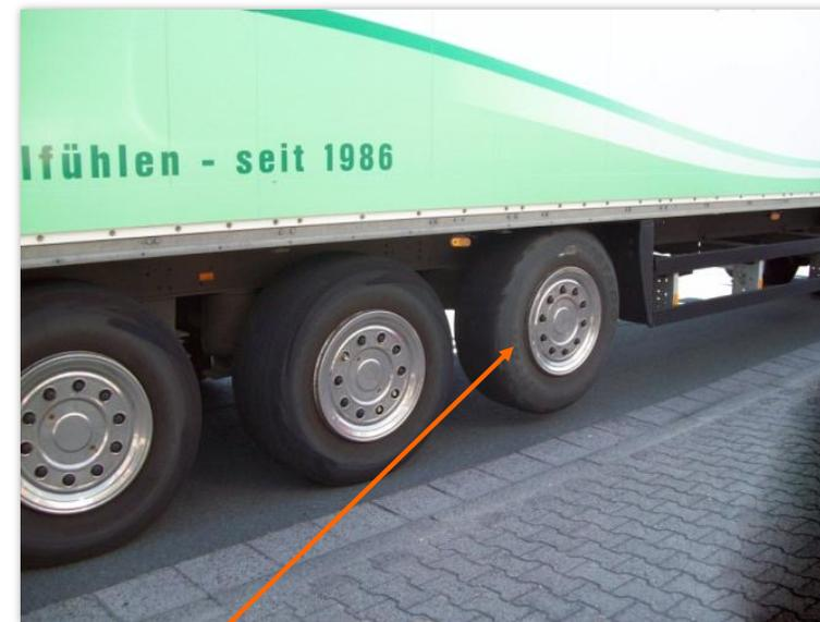
An der **Liftachse** keine Sicherung vornehmen.
