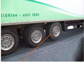
An der **Liftachse** keine Sicherung vornehmen.
