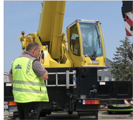
Bei Funkkontakt erst drücken und danach sprechen. Nur Arbeitsanweisungen durchgeben, Funkdisziplin!
