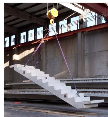
Auch durch verschieden lange Stränge oder ungleich verteilte Anschlagpunkte kann ein asymmetrischer Lastenanschlag entstehen.
